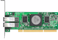
connecteur PCI-X 2.0 64 bits
