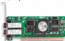
connettore PCI-X a 64 bit
